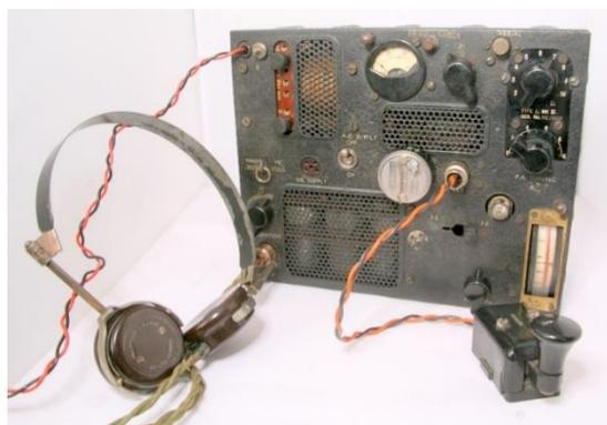
On distingue le fil torsadé allant au secteur, la borne « Terre », le sélecteur de tension, le milliampèremètre de réglage de l'émetteur, le contrôle de fréquence, le commutateur E/R, la plaquette gravée portant des deux boutons de réglage de l'émetteur.
